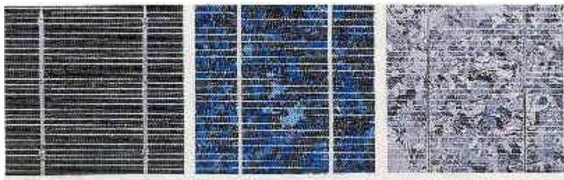
Tipologie di celle fotovoltaiche: 1) celle monocristalline, 2) celle poli-multi cristalline, 3) celle amorfe.
